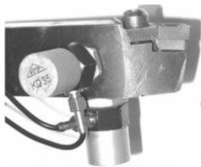
Рисунок 2.6. Схема крепления датчиков на резце
