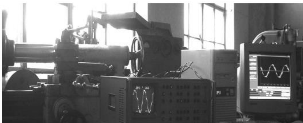
Рисунок 2.5. Общий вид экспериментальной установки по снятию сигналов виброакустической эмиссии при токарной обработке
